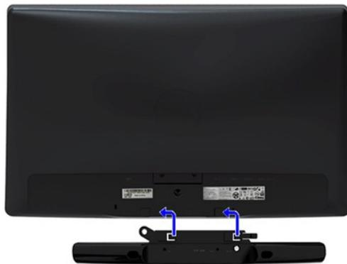
1. Von der Monitorrückseite aus befestigen Sie die Soundbar, indem Sie zunächst die beiden Schlitze mit den Zapfen an der unteren Monitorrückseite ausrichten.
